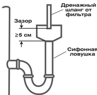
Наиболее оптимальным является установка фильтра выше уровня линии дренажа и на расстоянии не более 6,1 м от него. Используя подходящие фитинги (в комплект поставки не входят), присоедините пластиковый шланг к дренажному выходу на управляющем механизме. Диаметр и длину дренажной линии необходимо подбирать таким образом, чтобы обеспечить минимальное гидравлическое сопротивление при обратной промывке.
